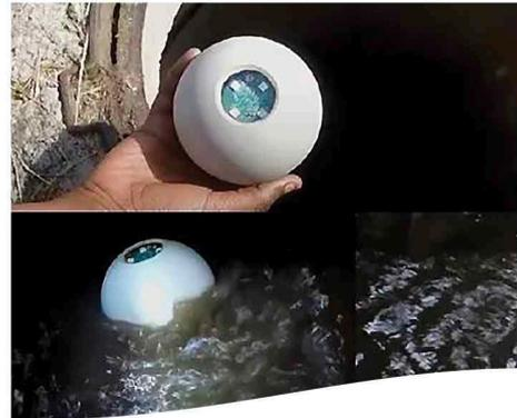
下水道智能球是一种动态的污水管网检测工具，用来识别和定位外水入侵。苏伊士的下水道智能球是一项突破性的解决方案，可以更好地保护环境。
